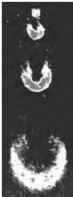
FIGURA 8. Làser d'àtoms: polsos de matèria que emanen d'un condensat, i que, per tant, estan constituïts per àtoms que evolucionen de manera coherent entre si. Els polsos cauen per la gravetat [11-13].
